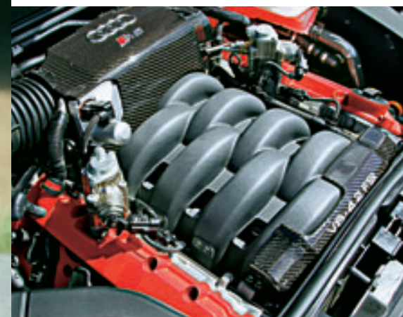
Geht gut, klingt gut und sieht auch noch verdammt gut aus: der 420 PS starke 4,2-Liter-V8-Saugmotor
